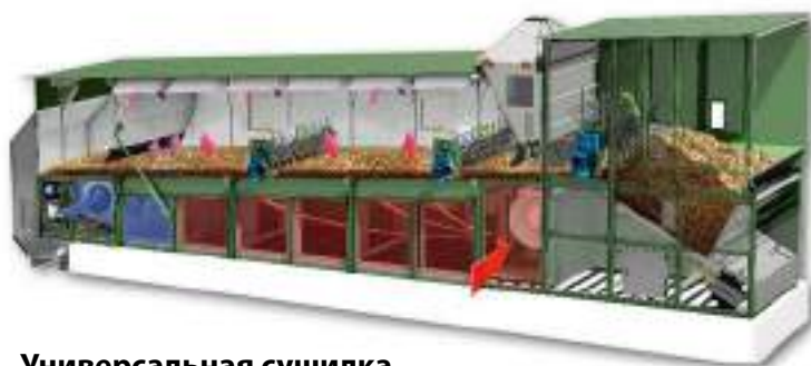
Универсальная сушилка Alvan Blanch конвейерного типа CD Сушка зерна, травы, бумаги, пластика, дегистата, жмыха. Продукты с большой начальной влажностью.
